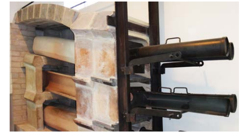
Originalgrosses Modell im Deutschen Museum in München. Schnitt durch einen Muffelofen. Hier sind die Muffeln dreilagig übereinander angeordnet. In Bellaluna gab es nur eine Muffellage. Ein Muffelofen benötigte zur Bedienung und täglichen Wartung 12 Schmelzer, 6 Zinkzieher und Hilfspersonal für die Ofenbefuerung.
